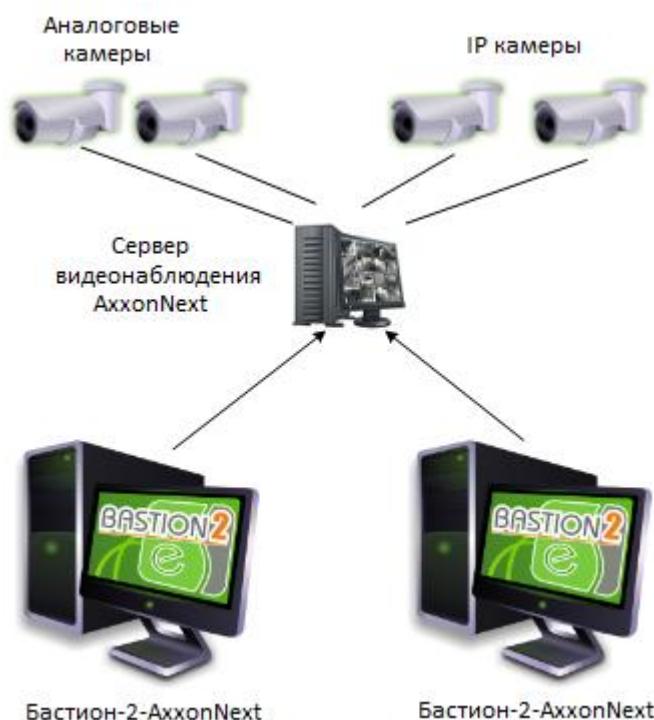
Рис. 1 – Схема работы драйвера «Бастион-2 – АххонNext»
